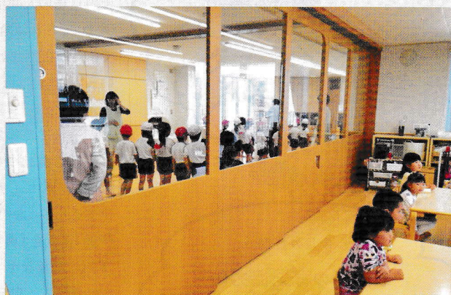
体操中の部屋の隣は工作中。工事前には隣が気になって集中できなかった子どもたちが、いまや誰ひとりとして振り向かず、集中しています。「天井の吸音がうまくいき、パーテーションが生きてきました」と志村先生。(写真提供:志村先生)
